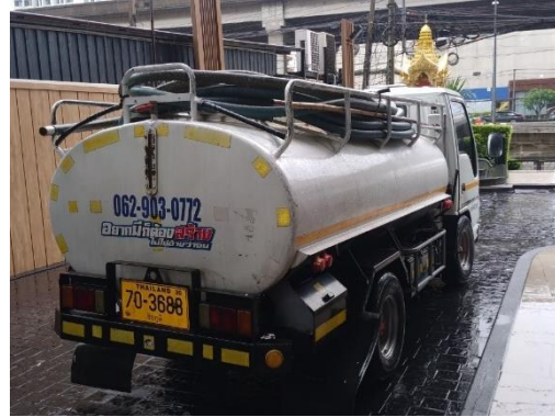
รถสูบน้ำระบบบำบัดน้ำเสีย
